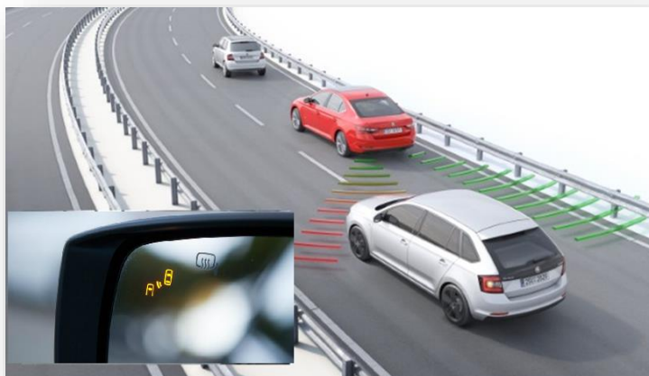
شکل ۱۰: نحوه عملکرد سیستم پایش نقاط کور خودرو
